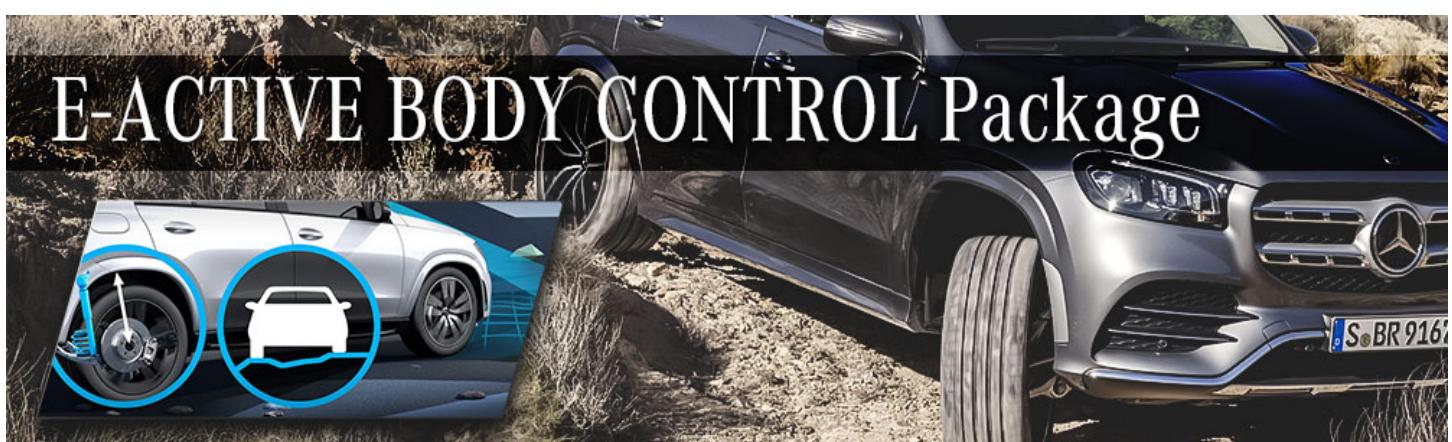
サスペンションは「AIRMATIC」エアサスペンションが全車標準装備となり、加えてオプションで48Vの電機システムを備え、ステレオカメラで路面状態を瞬時にスキャニングし、最適な乗り心地と走行安定性を自動設定、さらにはスタックからの脱出も可能という最新のサスペンション機構「E-アクティブボディコントロール」をオプション設定としています。
